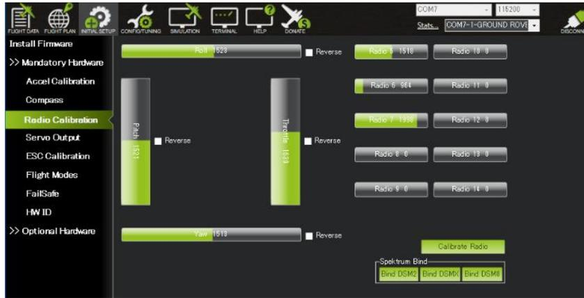
5. 点击“校准遥控”按钮，然后“确认”并检查遥控器是否开机、飞控是否上电、桨叶是否未安装。
