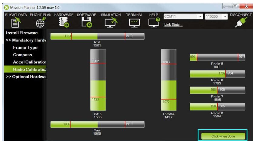
7. 最大、最小值校准完成后，点击确认，地面站会提醒“确保所有
