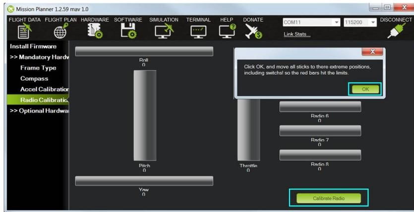
6. 推动遥控器的摇杆、旋钮、开关到最大限位。通道进度条上的红线表示校准迄今为止的最大最小值。
