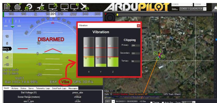
低于 30m/s/s 的震动水平通常是可以接受的。高于 30m/s/s 的水平可能会出现位置问题，而高于 60m/s/s 的水平几乎总是会出现位置保持或高度保持问题。
