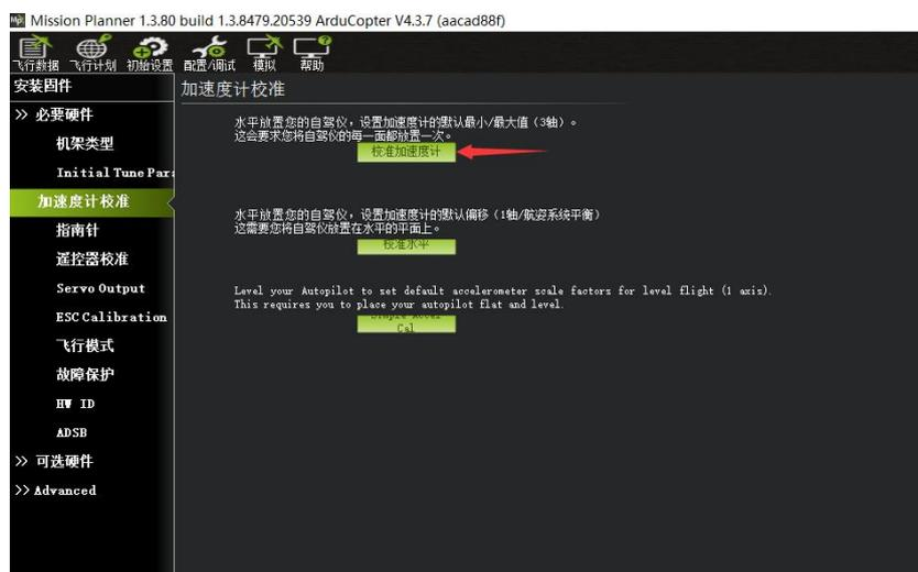
2. 点击“校准加速度”以开始完整的三轴校准。
